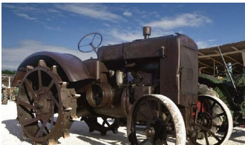
Traktor Deutz F2M315, Njemačka, 1940., 28 KS, 2475 kg
